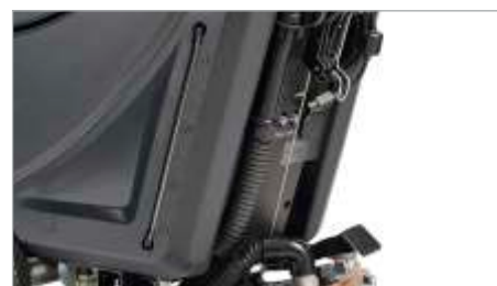
Indicador: Nível de água com o volume visível no tanque
