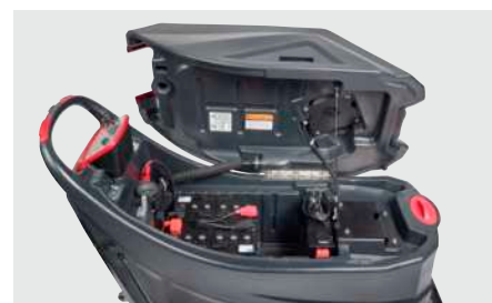
Tanque de recuperação com alça para facilitar na hora de levantar ou inclinar
